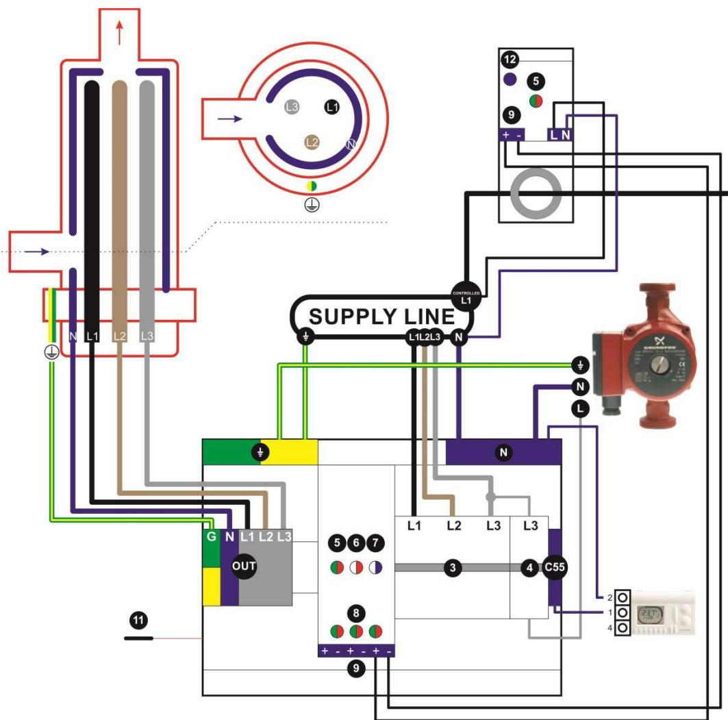
**Control panel thermostat / lebūvētais termostats / Встроенный термостат**
