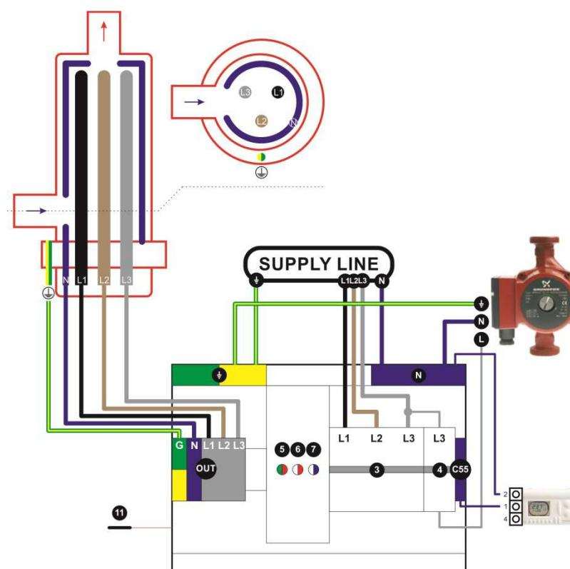
Three phase 3P control panel with maximal power controller STAFOR MPC connection schema / Trīs fāžu 3P vadības pults ar maksimālās strāvas kontrolieri STAFOR MPC pieslēgšanas shēma / Схема подключения трёхфазного 3Р пульта управления с контроллером максимального тока STAFOR MPC:
